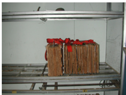
Fig. 16. Prensa dentro del secador. Nótese las resistencias y los cables de conexión. Foto: A. Soto.
